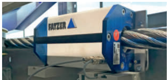
Dank einer weiteren Schnittstelle zum Seilprüfgerät TRUScan wird man zukünftig laufend über den aktuellen Seilzustand informiert sein.
