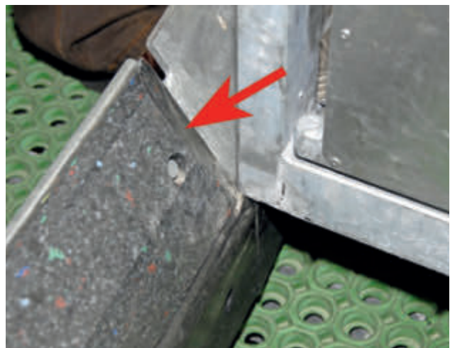
Abb. 4: Mögliche Position des in Fahrtrichtung gesehen rechten vorderen Ecks des Wagenkastens bei geringfügiger Schrägneigung. Das rot gekennzeichnete Ende des Kunststoff-Gleitbelags war zum Unfallzeitpunkt nicht abgeschragt und bildete daher eine ausgeprägte Kante, an der der Wagenkasten anstehen/einhaken konnte.
