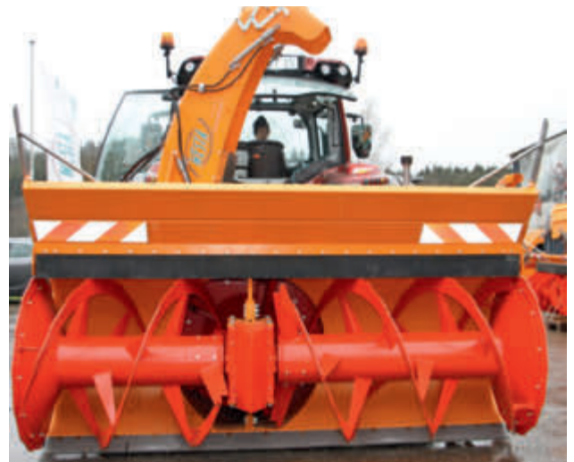
Die Schneefrässchleuder 950 mit einer Arbeitsbreite von 2.700 mm und einer Raumhöhe von 1.350 mm ist für hohe Räumleistungen ausgelegt.
