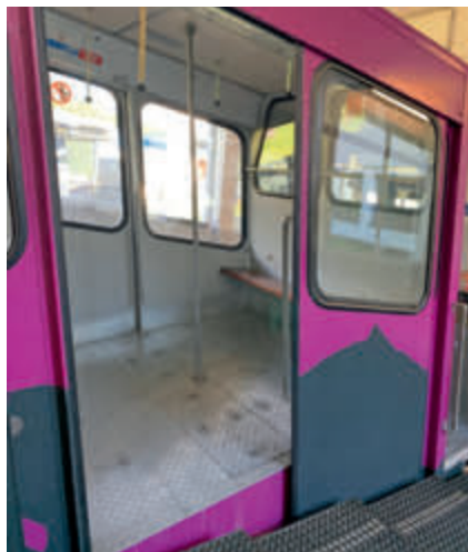
Fahrgastraum und Boden vor der Sanierung
