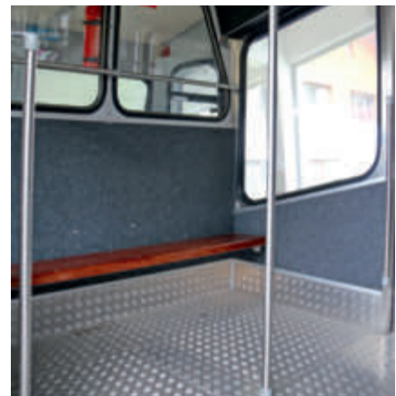
Fahrgastraum und Boden nach der Sanierung mit neuem Boden und der Kugelgarnverkleidung für Design und Schallreduktion.
