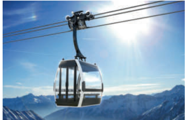
La nouvelle cabine CWA Stella avec un espace pouvant accueillir jusqu'à 20 personnes. L'intérieur peut être adapté de manière modulaire.
