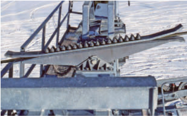
Fig. 6 : A la station amont, un dynamomètre situé au niveau de l'ancrage du câble de haubanage permet de surveiller la tension du câble. Du fait des rapports de levier de la construction le dynamomètre mesure un cinquième de la tension.
