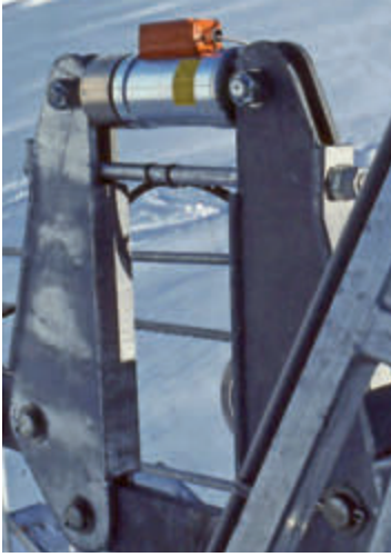
Fig. 6 : A la station amont, un dynamomètre situé au niveau de l'ancrage du câble de haubanage permet de surveiller la tension du câble. Du fait des rapports de levier de la construction le dynamomètre mesure un cinquième de la tension.
