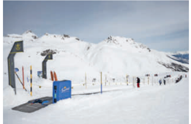
Das Förderband Sass Runzöl auf rund 2.400 m Seehöhe – die Bedienung erfolgt ferngesteuert von der Bergstation eines nahe gelegenen Schlepplifts.
