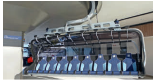
Le siège confort DCD 8 avec huit sièges individuels a été équipé pour la première fois d'un chauffage du dossier en plus du chauffage du siège.
