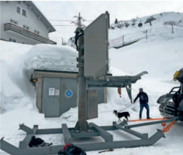
Der Schlitten verfügt über eine Anhängerkupplung für Pistenfahrzeuge, für Fahrten in Schräglagen ist er mit speziellen Kufen ausgerüstet.
