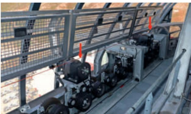
Für den Komfort-Stopp sind im Stationsumlauf der Bergstation im Ausstiegsbereich zwei separate Antriebe der Pneuförderer vorhanden (rote Pfeile).
