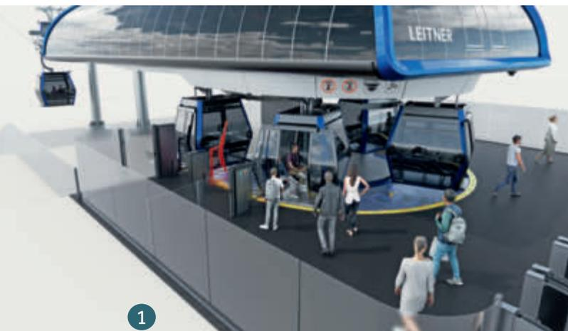
**1** *LeitPilot* permet une gestion sûre et autonome des stations de télécabines. Des caméras surveillent la zone d'embarquement et de débarquement ainsi que les alentours de la station.
