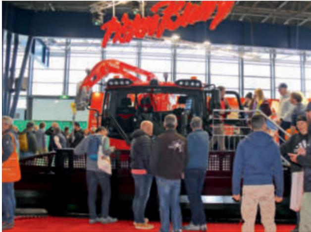
Machine haut de gamme Pistenbully 800 W avec une cabine plus grande et plus confortable; la lame *AllWayBlade* de 5,0 m de large (état replié) ou même de 5,95 m de large (état déplié) pousse encore plus de neige en moins de temps.
