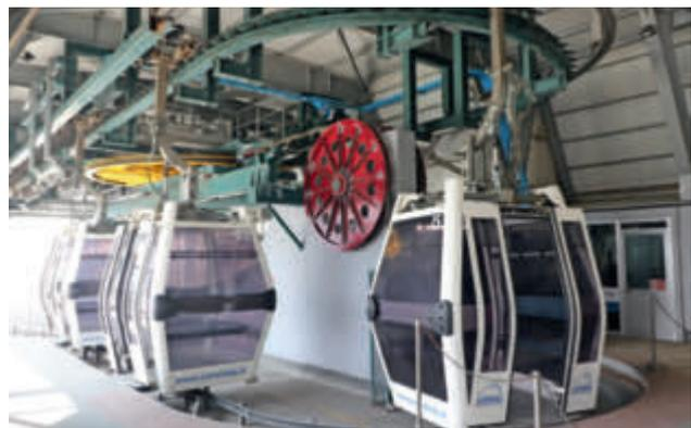
In der Bergstation Laghi Cime Bianche der 12er-Kabinenbahn wird das Förderseil gewichtsgespannt. Die zwei roten Seilscheiben lenken das Spannseil in den Spannschacht um.
