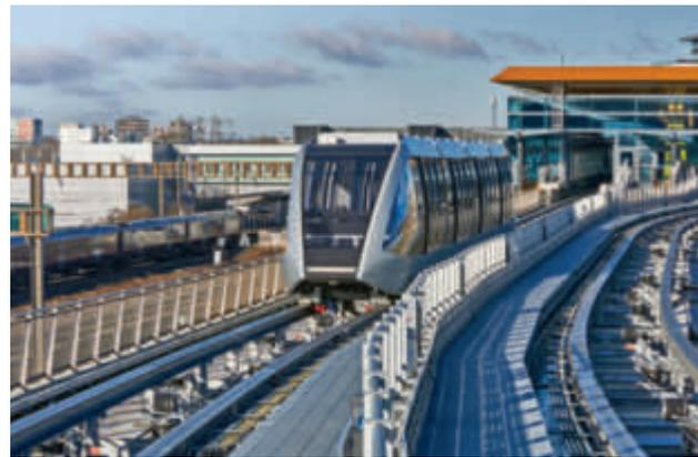
Im März 2023 ging in London das Cable Liner Shuttle *Luton DART* in Betrieb. Die DCC-Anlage verbindet den London Luton Airport mit dem Bahnhof St. Pancras International.
