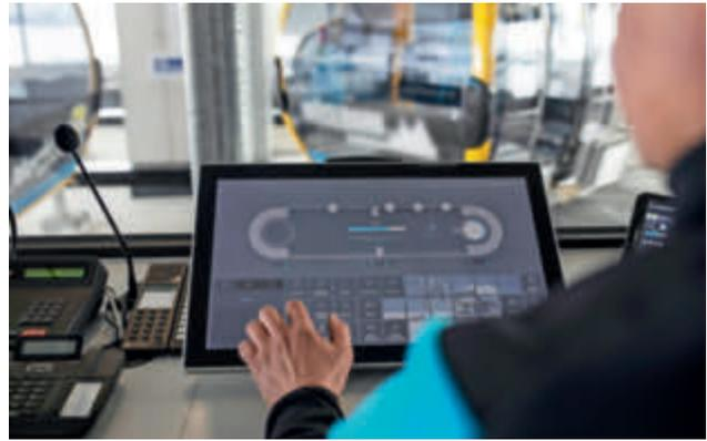
Das Hauptmenü zeigt auf einen Blick alles, was ein Bediener braucht: den Zustand der Bremsen, Windwerte, Warnungen an der Anlage, Betriebsart etc.
