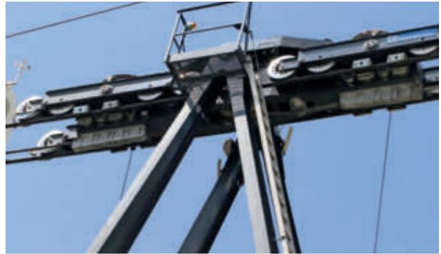
Das Laufwerk der Pendelbahn Testa Grigia ist mit acht Fangbremsen ausgerüstet, das obere und untere Zugseil ist mit dem Laufwerk mittels Trommelverankerung verbunden.
