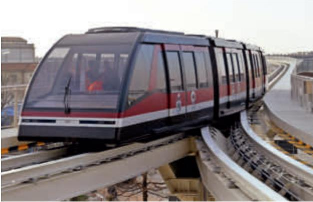
Der *People Mover* in Venedig: einer der beiden Wagenzüge des eingleisig mit Mittelstation ausgeführten *Cable Liner Shuttles* von DCC im Weichenbereich
