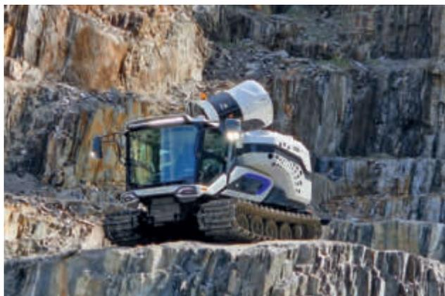
Das vollelektrische Kettenfahrzeug *Dust Cat* ist eines der ersten Produkte von Xelom. Es wurde für die Staubbekämpfung im Industriebereich entwickelt.
