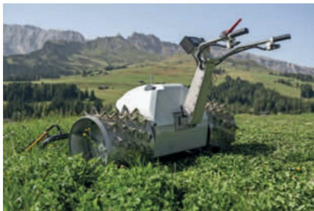
Das vollelektrische Mähgerät *Alpin 10* verfügt über ein Schnellwechselsystem für Batterien und wurde speziell für steile Hänge entwickelt.
