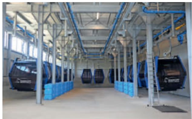
Im neu gebauten automatischen Abstellbahnhof neben der Bergstation werden alle 65 Kabinen garagiert.
