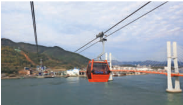
Tourismusattraktion in Südkorea in der Hafenstadt Sacheon: Sacheon Ocean Cable Car ist eine Zweiseil-Umlaufbahn (Leitner) mit 10er-Kabinen samt tollem Blick aufs Meer.
