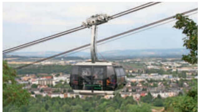
Die für die Gartenausstellung BUGA 2011 in Koblenz (D) gebaute 3S-Bahn (Doppelmayr-Gruppe) ist weiterhin als urbane Seilbahn in Betrieb.
