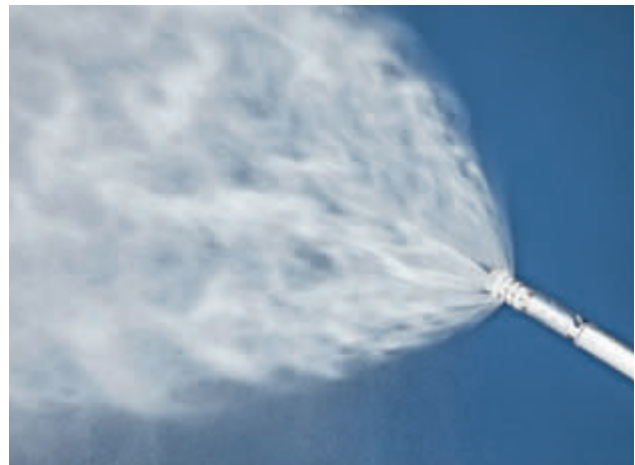
Bei den Lanzen (im Bild TL8 Schneilanze) wurde die Anzahl der Regelstufen erhöht und die Düsenbestückung an den Grenzbereich angepasst.
