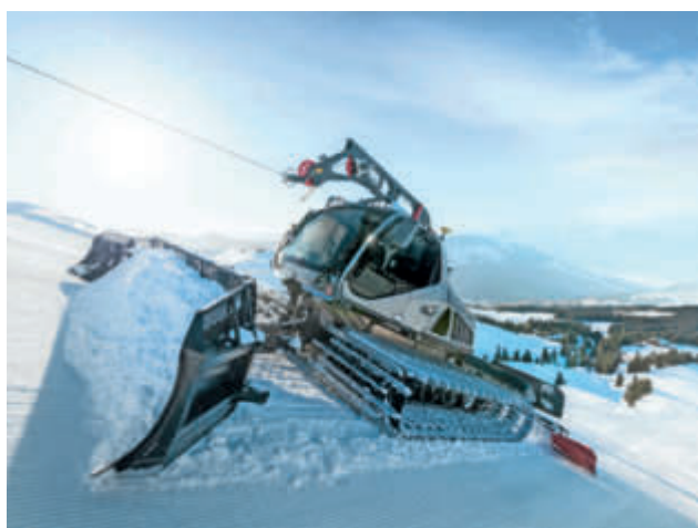
Der zentrale Schwerpunkt des Fahrzeugs sorgt für eine stabilere Fahrt und bessere Traktion bei allen Pistenverhältnissen.
