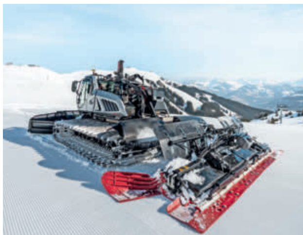
Schild, Fräse und Finisher: aufeinander abgestimmte Komponenten für ein schönes Pistenbild
