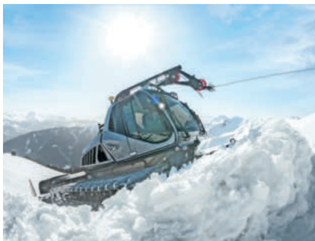
Breite und Kontur des Schiltes beeinflussen, wie viel Schnee geschoben werden kann.
