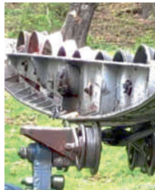
Abb. 7: Das Laufwerk bei der Fahrt unterhalb der Schienen der Niederhaltestütze
