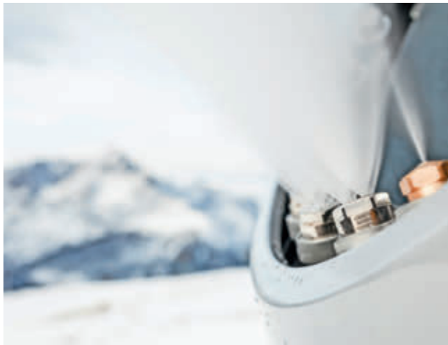
Düsen und Nukleatoren der gesamten Produktpalette von TechnoAlpin (im Bild TR9 Schneekanone) werden ständig optimiert.
