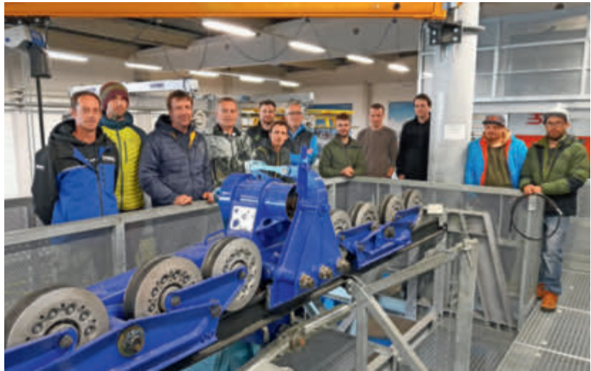
Teilnehmer des BL-Systemkurses Schlappseilversuch bei einem Pendelbahnlaufwerk im Seilbahnkompetenzzentrum Hallein
