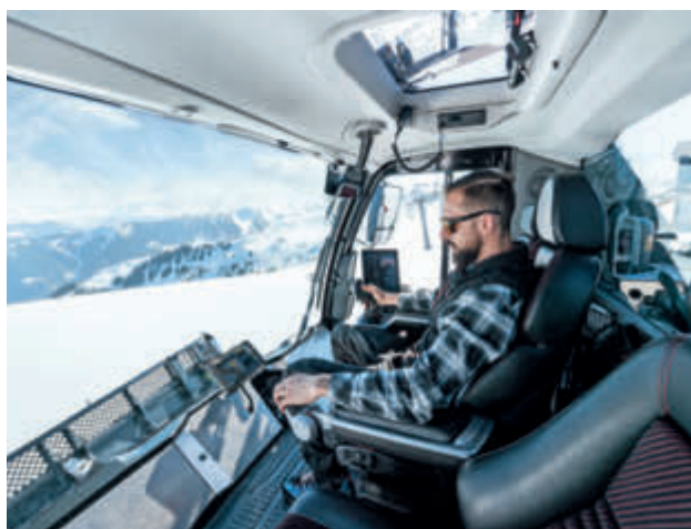
Mittelsitz, Rundumsicht und Prinoth Control Unit erleichtern die Arbeit der Fahrer wesentlich.
