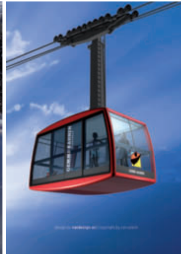
Le télésiège 6 places débrayable des Arcs, Mont-Blanc. Le nouveau téléphérique à va-et-vient de Leukerbad
