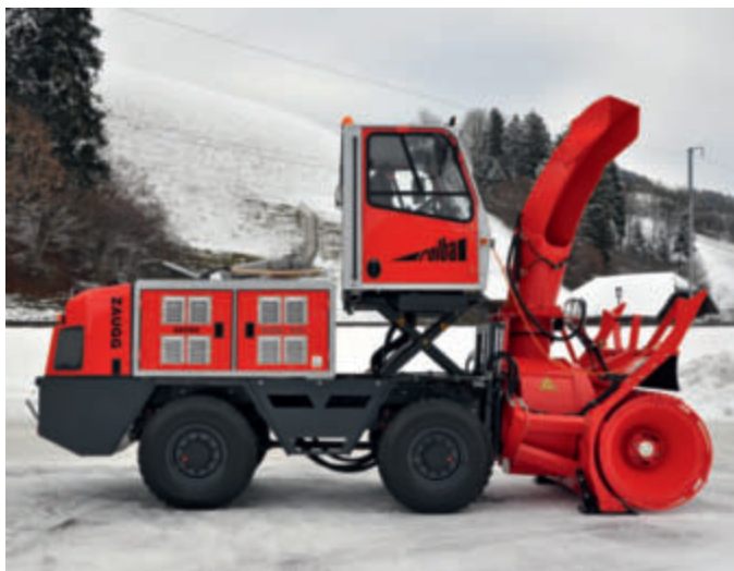
El conductor tiene una vista siempre perfecta desde la cabina con altura regulable de la máquina Rolba.
