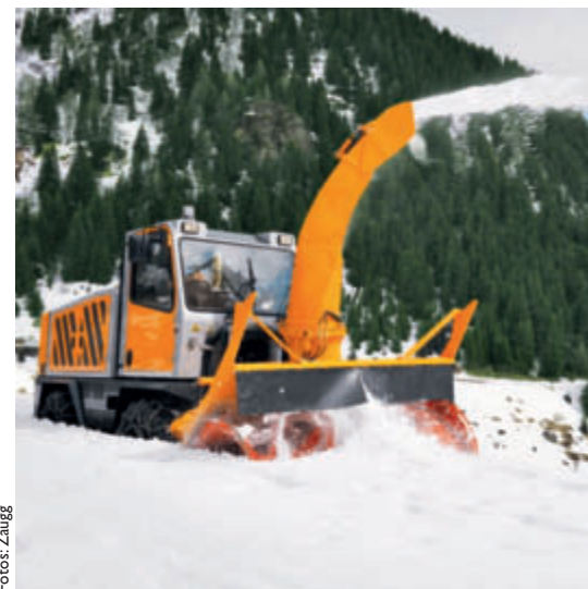
La turbofresadora autopropulsada Rolba , usada en alta montaña.
