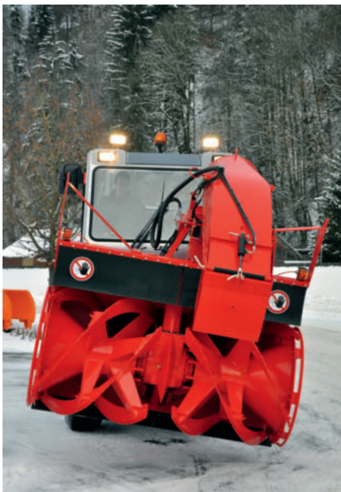
Gracias a la inclinación transversal de regulación continua, la turbofresadora se adapta perfectamente a todo tipo de terreno.
