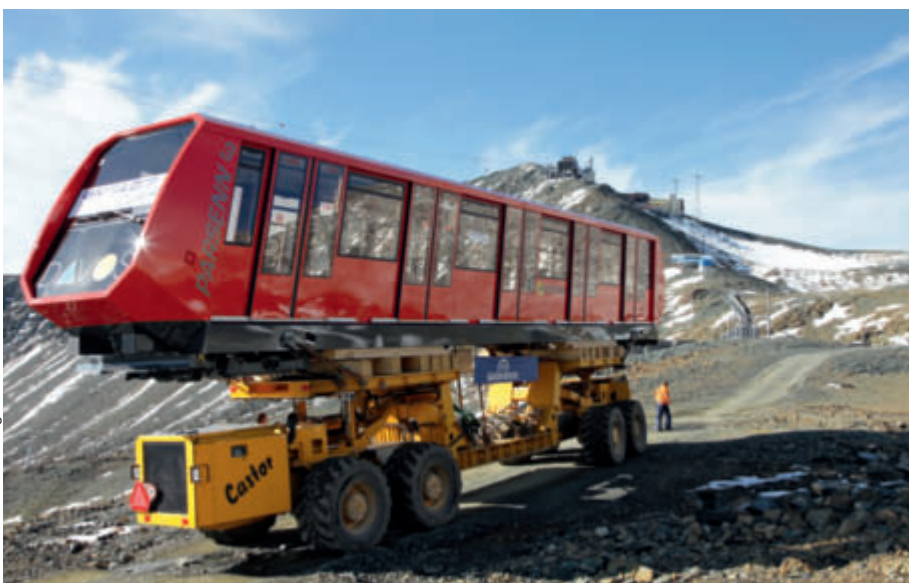
Der Transport eines der beiden 16 t schweren und 17 m langen Wagen der 2. Teilstrecke der Parsennbahn
