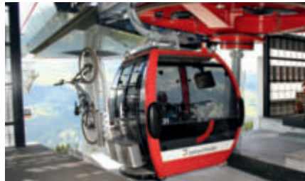
Die Mountain-Bikes werden an den Omega IV-8 LWI-Kabinen der Rothornbahn I mittels der neu entwickelten, direkt in den Skikorb montierten Träger „Bike Rack Varia“ von CWA transportiert.
