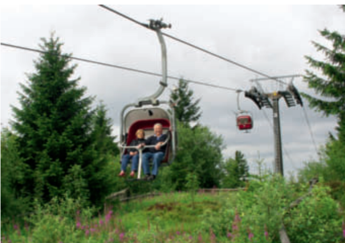
Im Skigebiet Ochsenkopf im Fichtelgebirge wurden schon im Jahr 1968 die fixen Doppelsesselbahnen Ochsenkopf-Nord und Ochsenkopf-Süd gebaut. In den Jahren 1991 und 1997 wurden beide fixe Sesselbahnen durch kuppelbare Doppelsesselbahnen der Marke Leitner mit Wetterschutzhauben ersetzt. Beide Bahnen sind auch im Sommer in Betrieb, die nördliche Bahn bedient im Sommer mittels einer Mittelstation auch eine Sommerrodelbahn.
