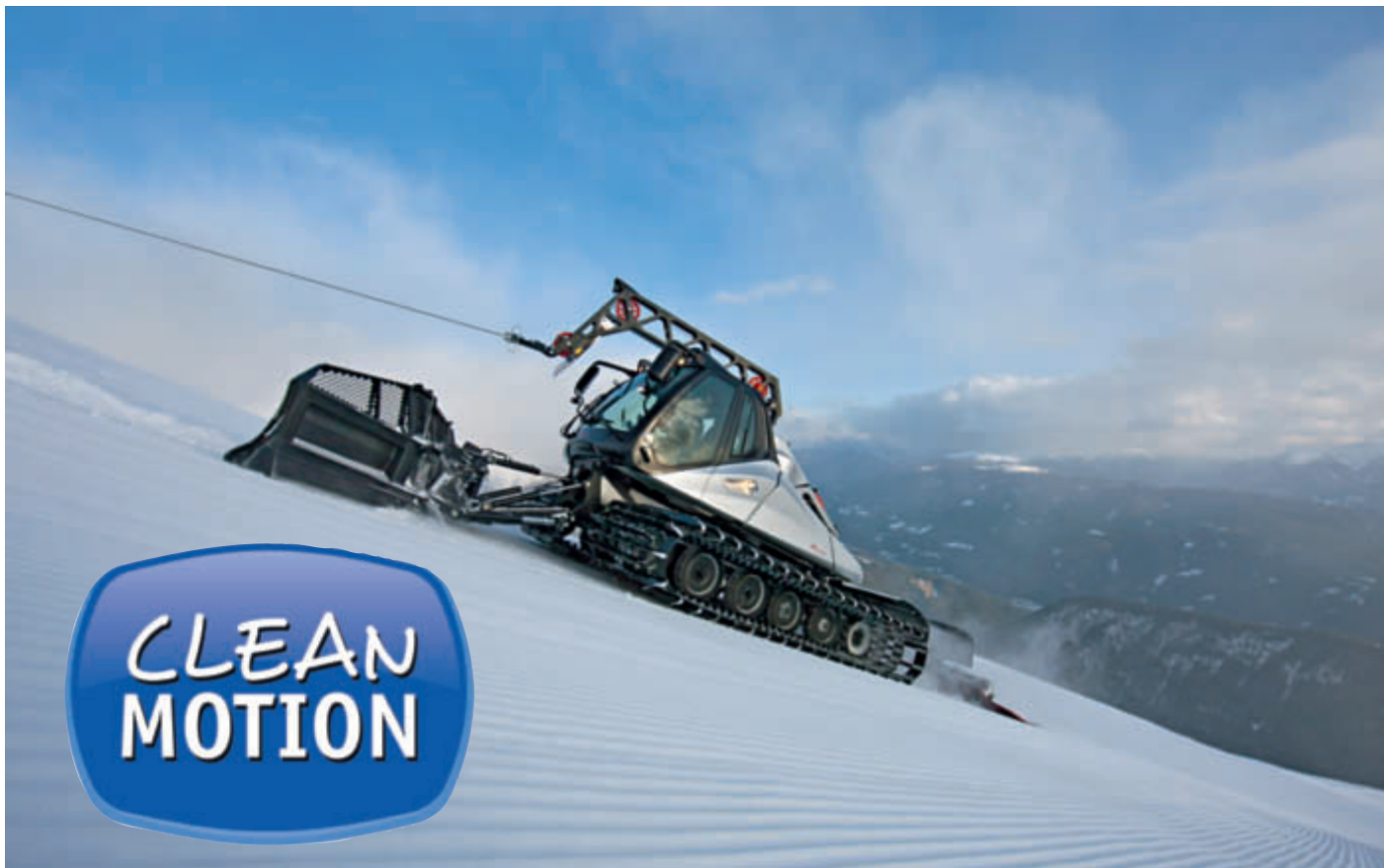
Mit dem Husky E-Motion setzt Prinoth auf diesel-elektrische Lösungen
