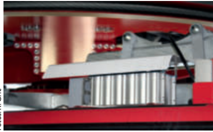
Zur Stromversorgung des Multimedia-Systems in den Kabinen dienen am Kabinendach angebrachte „Super-Caps“.
