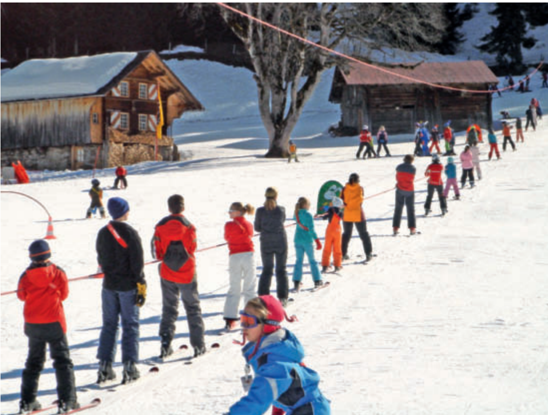
Hasliberg (CH): Der SwissCord als Anfängerlift; im Bild sehr gut zu erkennen ist das vertikal oberhalb der Passagiere geführte Rücklaufseil.
