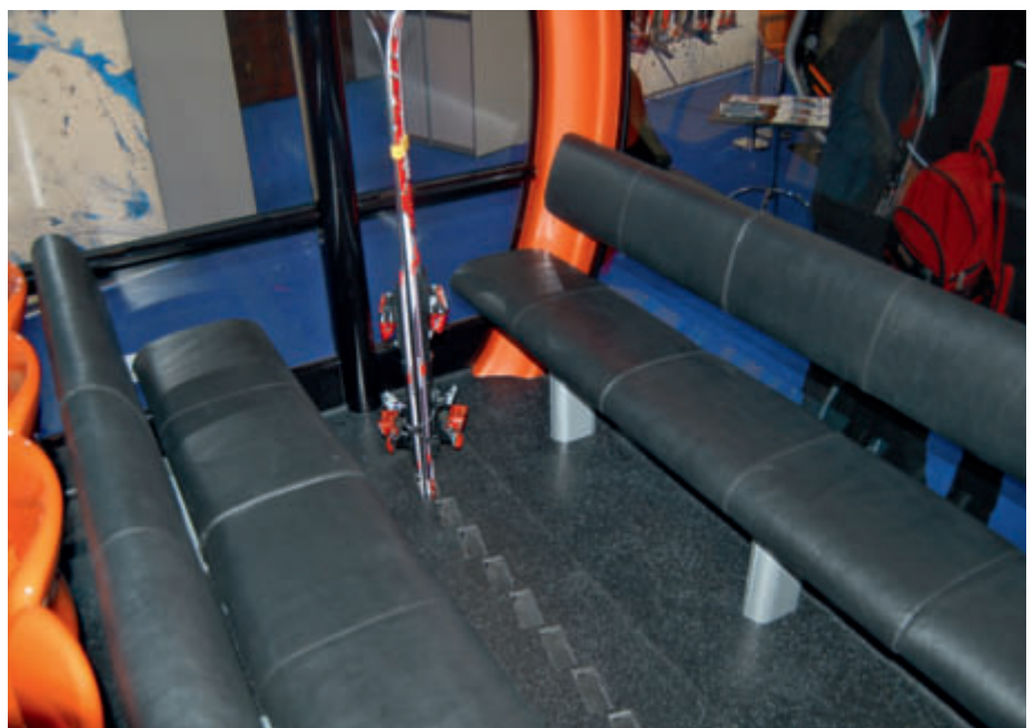
Le modèle de la TARIS que l'on pouvait voir au salon présentait différentes exécutions de sièges et était équipé de porte-skis dans le plancher.
