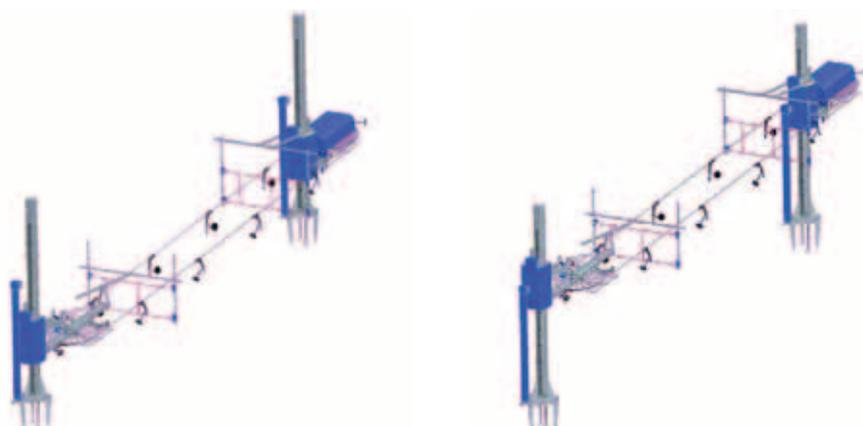
Das Highlight des Mega-Comfort-Star ist die motorische Höhenverstellung: Position unten für den Liftbetrieb (links), Position oben zur Präparierung der Liftrasse (rechts).
