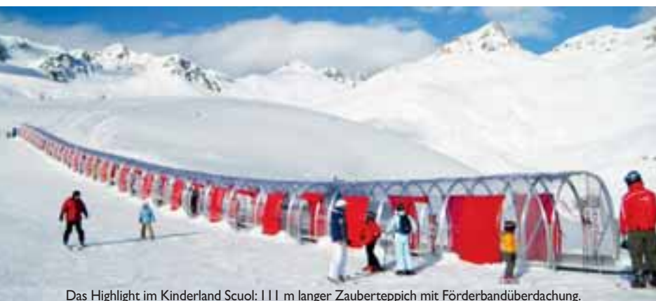
Das Highlight im Kinderland Scuol: 111 m langer Zauberteppich mit Förderbandüberdachung.
