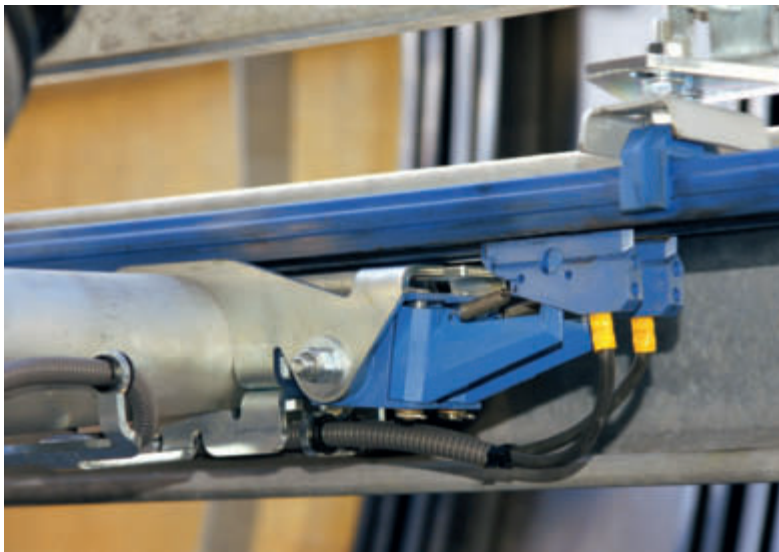
Abb. 5: Die Stromabnehmer für die Sitzheizung, angebracht an der Gehängeachse des Fahrzeuges
