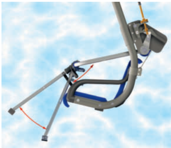
Abb. 6: Schemazeichnung des 4er-Sessels mit beweglichen Fußrastern und kidstop®. Die Schwenkbereiche des Fußrasters und der kidstop®-Einrichtung sind durch rote Pfeile dargestellt.
