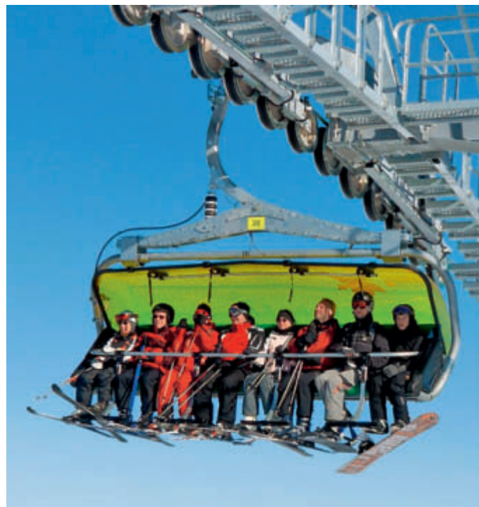
Abb. 2: Ein 8er-Komfortsessel mit gelb getönter Wetterschutzhaube
