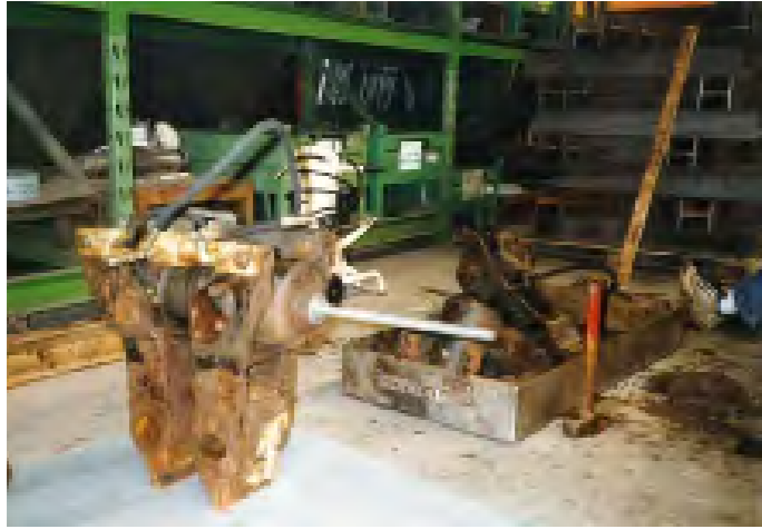
Bild oben: Standseilbahnfahrwerk in ausgebautem Zustand Bild unten: Schienenzangenbremse in ausgebautem Zustand
