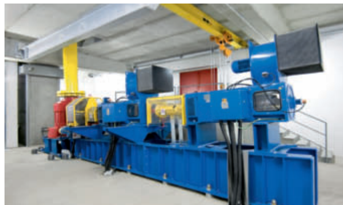
Unterflurantrieb mit zwei fremdbelüfteten Gleichstrommotoren in Tandemanordnung
