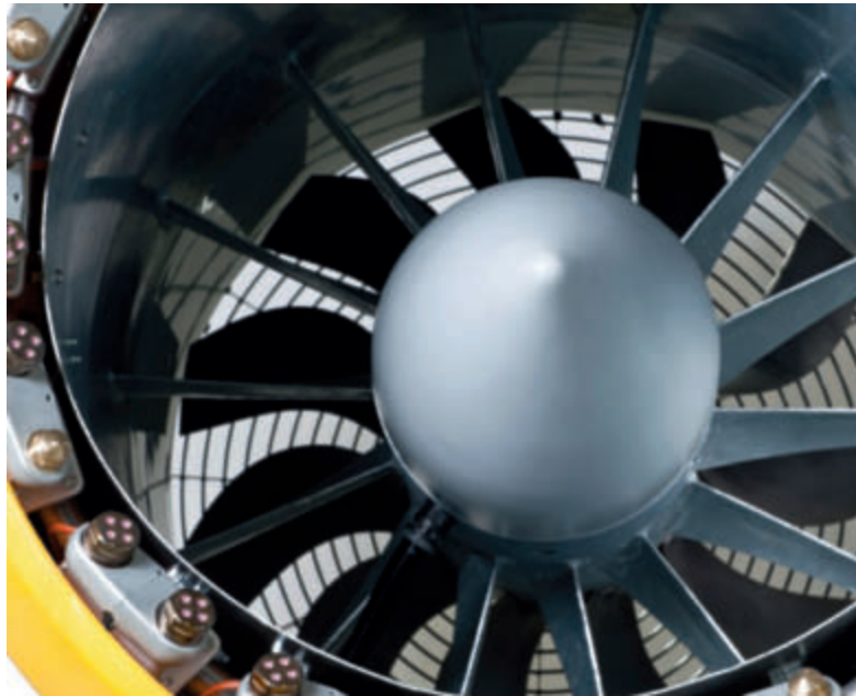
Новая турбина с внутренним электродвигателем имеет частоту вращения 1500 об/мин, что делает аппарат виброустойчивым и значительно снижает шумовую эмиссию.
