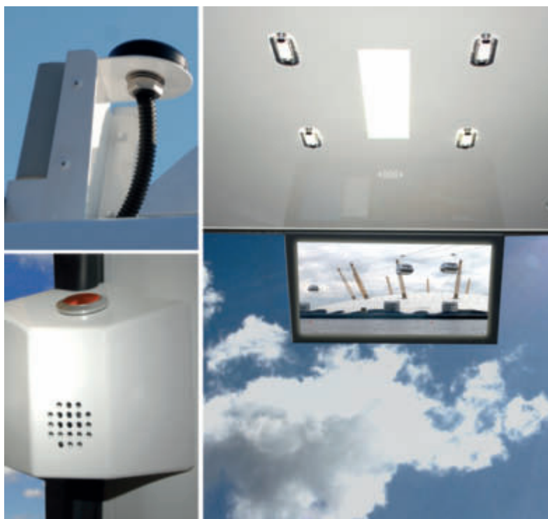
Обзор оборудования (WLAN / GPS / освещение / CCTV / ЖК-экран / система внутренней связи)
