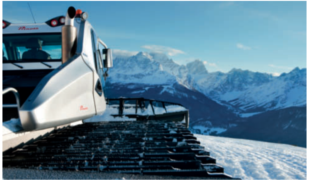
Beast имеет исключительно большую площадь контактной поверхности гусениц
