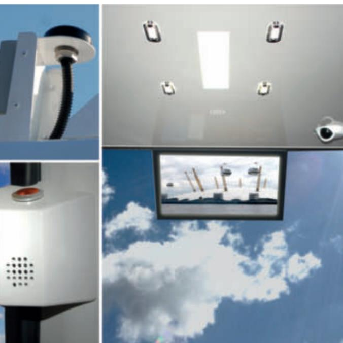
Элементы оснащения кабины (WLAN / GPS / освещение / CCTV / ЖК-экран / система внутренней связи)
