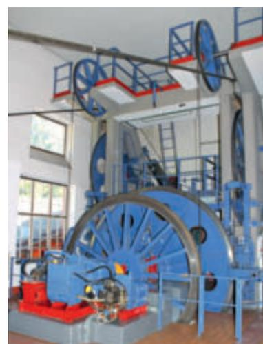
**Im Maschinenraum in der Bergstation ist der Notantrieb (vordere kleinere Antriebs-scheibe mit Antriebsaggregat) und der Hauptantrieb (hintere größere Antriebs-scheibe) einschließlich der Umlenkscheiben untergebracht.**
