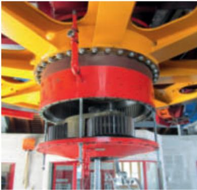
Abb. 2: Der untere Teil eines VKE-V-Getriebes in geöffnetem Zustand
