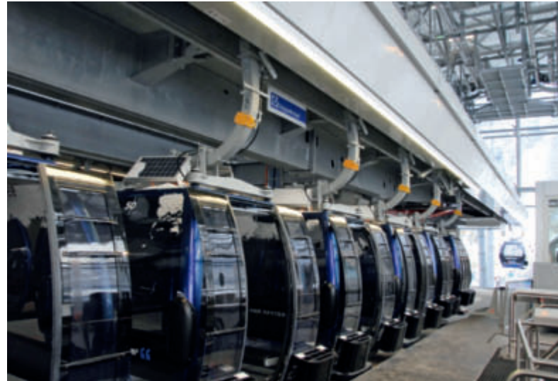
Bild 3: Der lange Einstiegsbereich der 8er-Kabinenbahn ermöglicht eine theoretische Förderleistung von 3.600 P/h.
