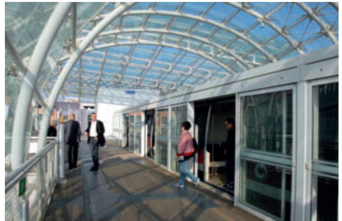
Die Bahnsteigtüren öffnen und schließen gleichzeitig mit den Fahrzeugtüren.
