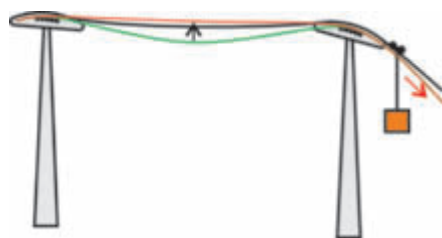
Bild 2: Zugseilwellenschwingung bei Stützenüberfahrt zufolge Änderung der Zugwirkung der Fahrzeuge
