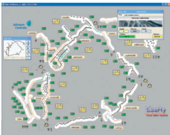
Bildschirmdarstellung der Pisten und Elemente der Beschneiungsanlage („TrailView“)
