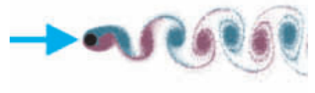
Bild 9: Kármánsche Wirbel hinter einem Körper mit kreisförmigem Querschnitt
