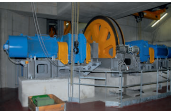
Antrieb im Erdgeschoß der Station Tronchetto
