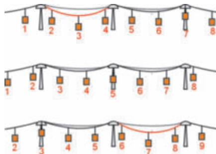
Bild 8: Regelmäßige Bewegung der Fahrzeuge durch die Seilfelder kann zu „Pumpschwingungen“ führen, insbesondere dann, wenn die benachbarten Felder vergleichbare Längen aufweisen.
