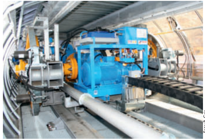
Antrieb der Funifor Passo dei Salati – Punta Indren mit zwei senkrechten Antriebsscheiben
