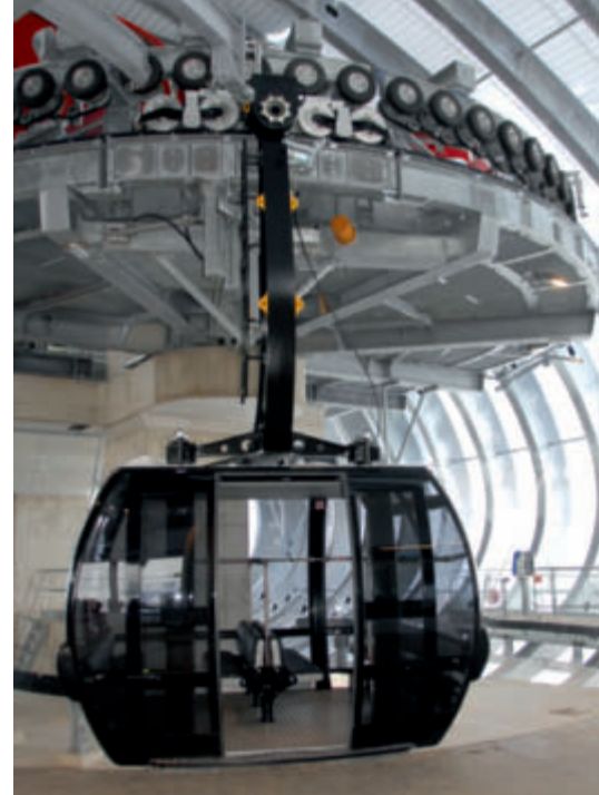
Bild 6: 30er-Kabine der 3S-Bahn im Stationsumlauf
