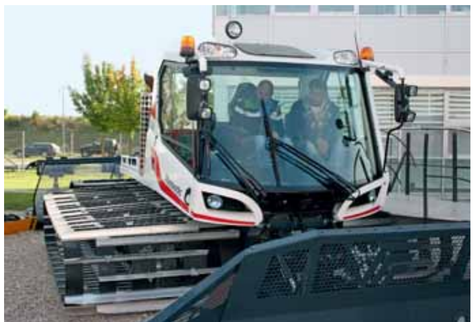
Der Formatic 350 mit einer Flächenleistung von bis zu 120.000 m 2 /h
