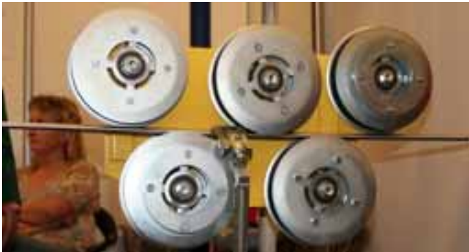
Diese neuentwickelte Schleplift-Rollenbatterie des tschechischen Herstellers T & S Mazák, die als Trag-, Niederhalte- oder Wechsellastbatterie verwendet werden kann, hat auf der Messe viel Aufmerksamkeit erregt.
