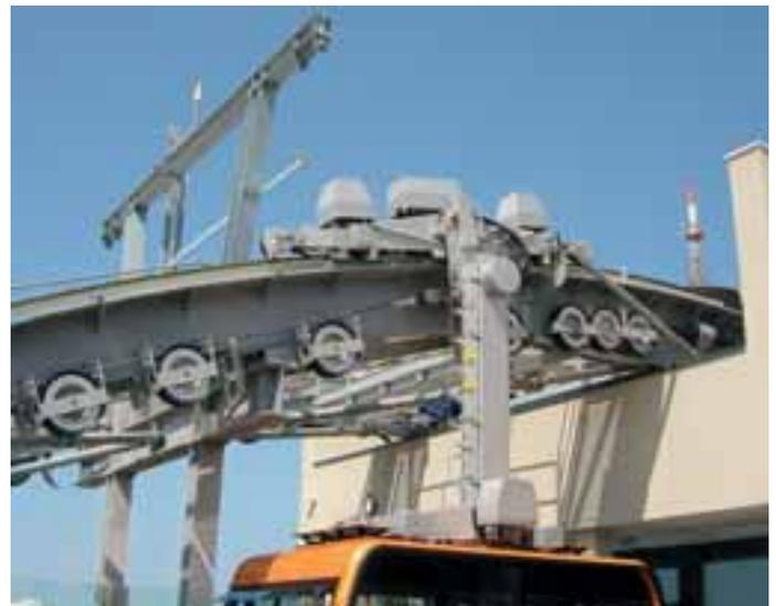
Laufwerk und Gehänge der 30-Personen-Kabine auf dem Stationsschuh der Bergstation
