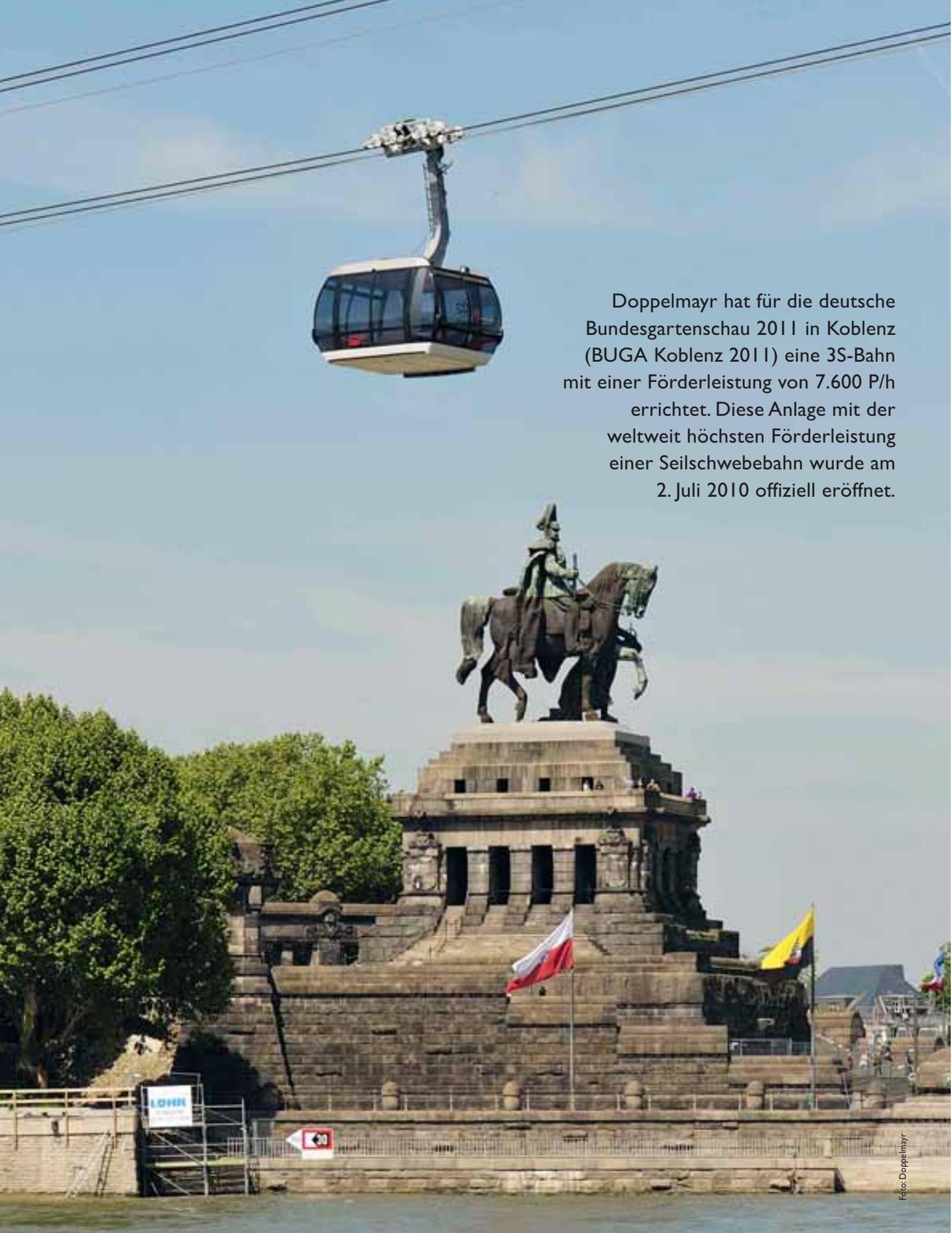
Doppelmayr hat für die deutsche Bundesgartenschau 2011 in Koblenz (BUGA Koblenz 2011) eine 3S-Bahn mit einer Förderleistung von 7.600 P/h errichtet. Diese Anlage mit der weltweit höchsten Förderleistung einer Seilschwebbahn wurde am 2. Juli 2010 offiziell eröffnet.
