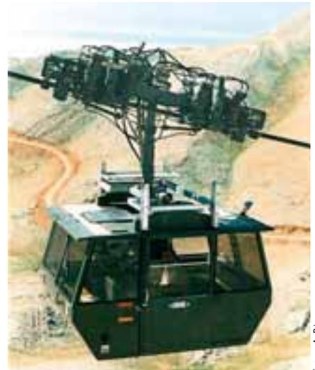
Abb. 2: Seilbahnwagen der Pendelbahn auf den Mount Hermon mit hydraulischem Selbstfahr-Antrieb
