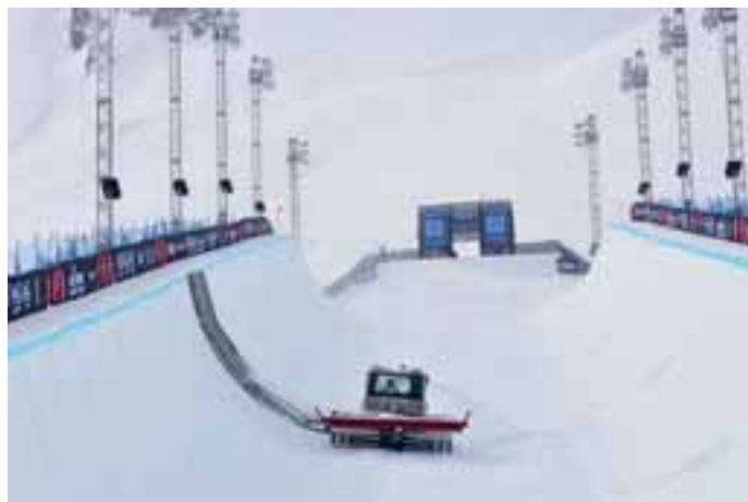
Superpipe construit par un BISON X équipé d'une fraise Pipemonster Zaugg.
