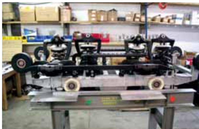
Les chariots du D.M.C. de Flaine pourvus de quatre pinces Poma en T sont révisés régulièrement dans les ateliers de la société.
