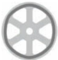
Bild 5: Polygonalität einer Scheibe z. B. in Folge ungenügender Steifigkeit der Felge
