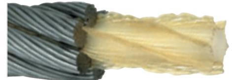
Unsere STABILO-Seile setzen neue Massstäbe für die Lebensdauer von Seilbahnseilen. In einem innovativen Herstellungsverfahren betten sich die Litzen gleichmässig in den Seilkern ein. STABILO-Seile bestechen deshalb durch eine ebenso kompakte wie stabile Verfüllung mit hervorragenden Eigenschaften. Der Seildurchmesser bleibt konstant und die Längung marginal – auch auf Hochleistungsbahnen mit grosser Transportkapazität.
