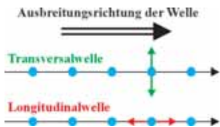
Bild 4: Transversal- und Longitudinalwelle
