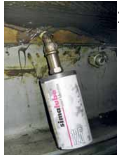
Automatische Schmierung des Tragseilschuhs mit simalube
