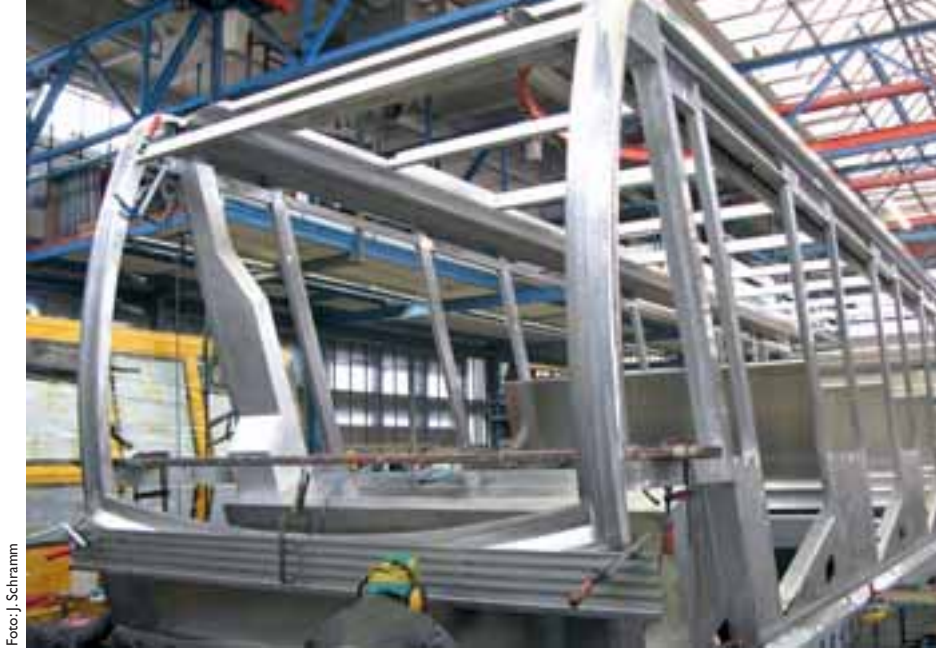
Einer der beiden Standseilbahnwagen (90+1) für Raschötz in der Produktionshalle
