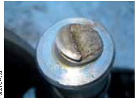
Abb. 3: Bruchbild am Gewindeansatz der Führungsrollenachse
