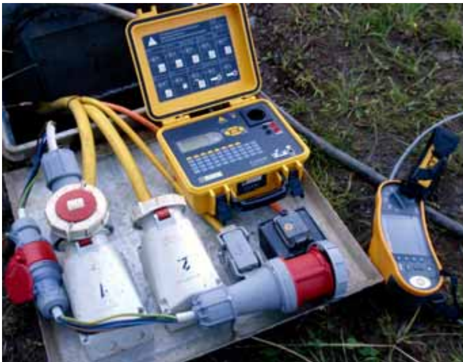
Messaufbau für Messung eines Schneerzeugers am Feld
