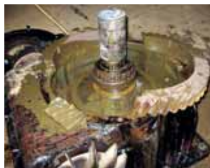
Der Zahnkranz der Antriebswelle des als Schneckengetriebe ausgeführten Hauptgetriebes war gebrochen.
