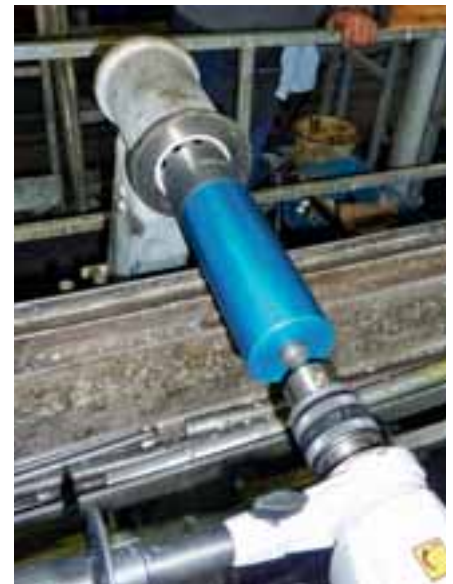
Abb. 3: Das „GeroVari“-Reibwerkzeug im Einsatz
