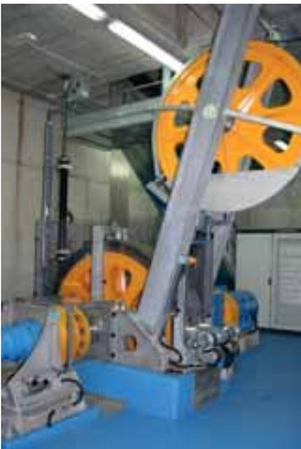
Der Antrieb befindet sich in der Talstation, links unten die Antriebsscheibe, rechts oben eine der Umlenkscheiben.
