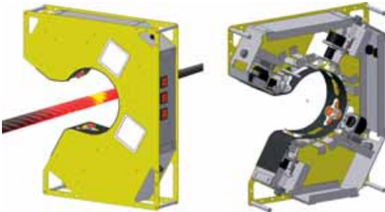
Représentation 3D de l'appareil de contrôle des câbles, à droite avec boîtier ouvert, à gauche avec boîtier fermé.
