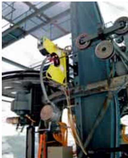
L'appareil de contrôle des câbles est testé sur un téléski
