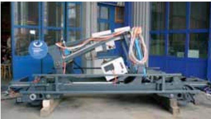
Standseilbahnfahrwerk für Wagen der beiden neuen 15er-Anlagen in Deer Crest, USA mit niveaugeregelten Fahrgastabteilen
