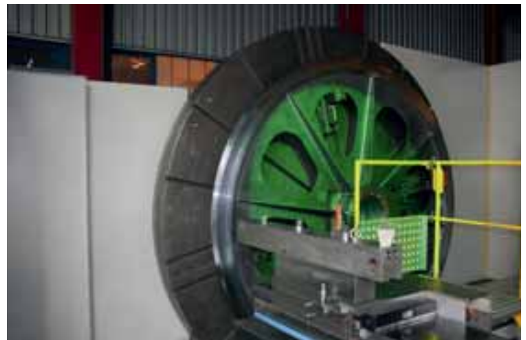
Kopfdrehbank zur Bearbeitung der Seilscheiben
