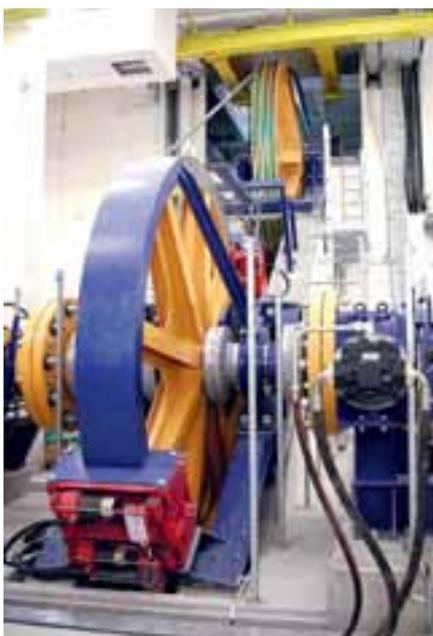
Abb. 5: Zweirillige Antriebsscheibe, Ablenkscheiben und Gegenscheibe in der Bergstation
