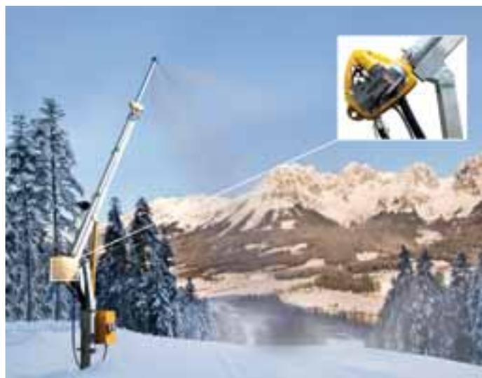
Der Oberflurventilblock wird direkt an das Lanzenrohr angeflanscht.
