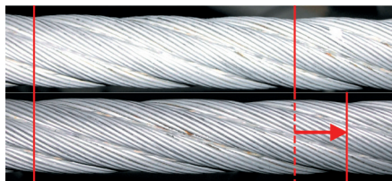
Bild 7: Änderung der Schlaglänge vor und nach einer Fahrzeugklemme infolge falscher Ausrichtung von Seilführungselementen
