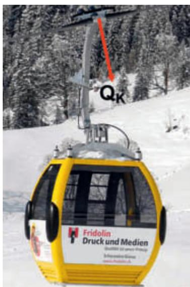
Abb. 3a: Biegebeanspruchung des Förderseiles an der Klemme eines Seilbahnfahrzeugs.  $Q_K$  ... Klemmen-Querkraft
